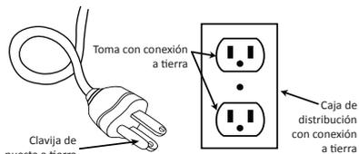
Este producto se utiliza en un circuito nominal de 120 voltios y tiene un enchufe con conexión a tierra que se parece al enchufe que se muestra en el boceto (A). Asegúrese de que el producto esté conectado a una toma de corriente que tenga la misma configuración que el enchufe. No se debe usar ningún adaptador con este producto.
